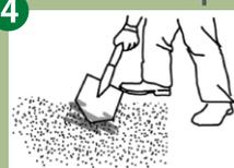
Puede agregarse al final sobre la grama una capa de arena sílice 20/30 en espesor de 1 cm. Cepillar o aplicar rastrillo plástico a la grama suavemente para levantar las cerdas sobre la arena.
