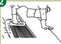
Personal especializado debe instalar el césped mediante orientación adecuada de los rollos y pegado a la superficie base con un adhesivo de contacto adecuado.
